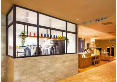
通路側よりガラス張りの工房をのぞむ。メタルハライドランプ70W相当の「レディオック LEDダウン ライト クラス550」で設計照度1600ℓxを確保し、明るく清潔感のある印象としている。
